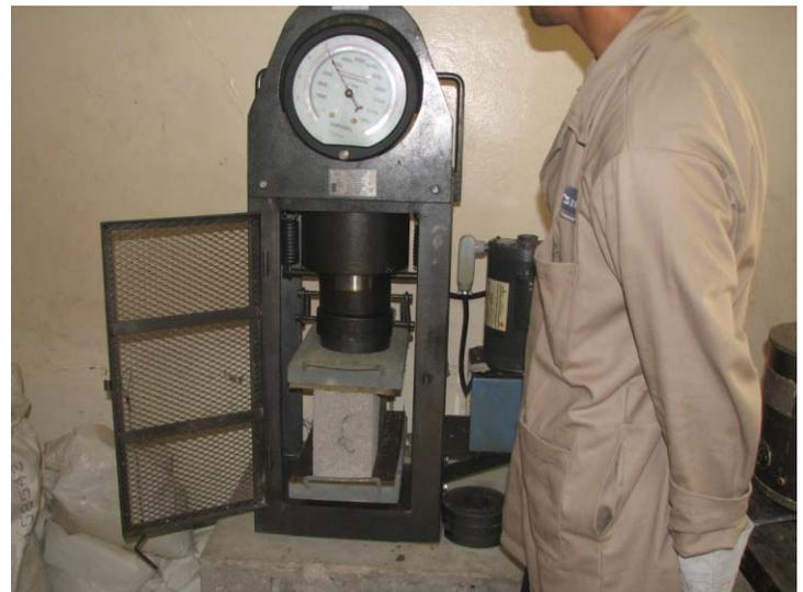
**//Ensayo de cilindro y block de concreto**
